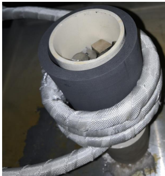
Шихта в тигле для литья. Тигли – из НПО «Технология»
