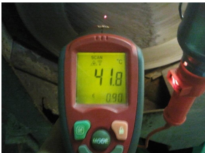
Рисунок 6.8 – Измерение температуры в зоне разгрузки гранул
