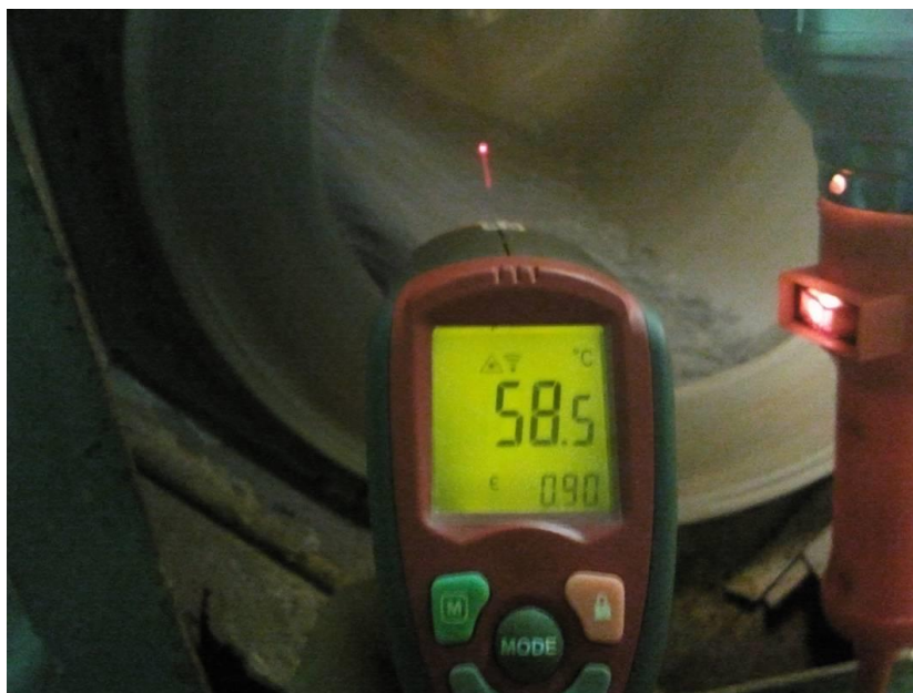
Рисунок 6.7 – Измерение температуры в зоне первичного контакта рудного материала с раствором
