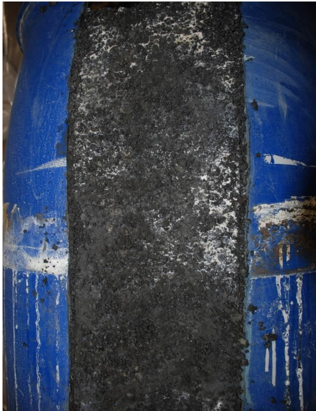
Рисунок 6.13 – Внешний вид рудного материала в заиленной бочке. Белые прожилки – нерастворимые гидроксиды.
