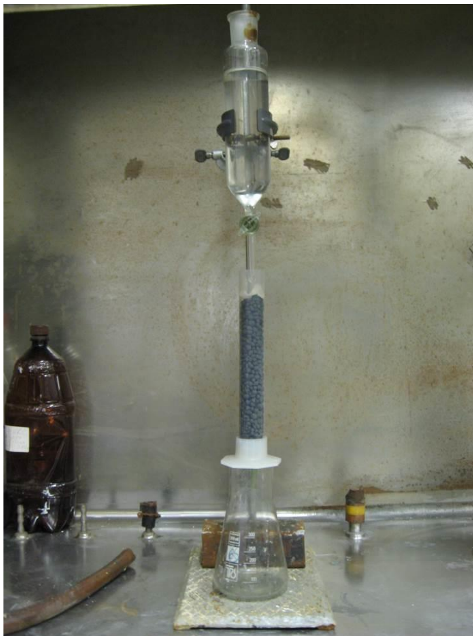
Рисунок 2.3 – Перколяционная колонка с гранулированной рудой
