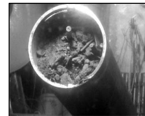
Фрагменты разрушенных ТВЭЛОВ
