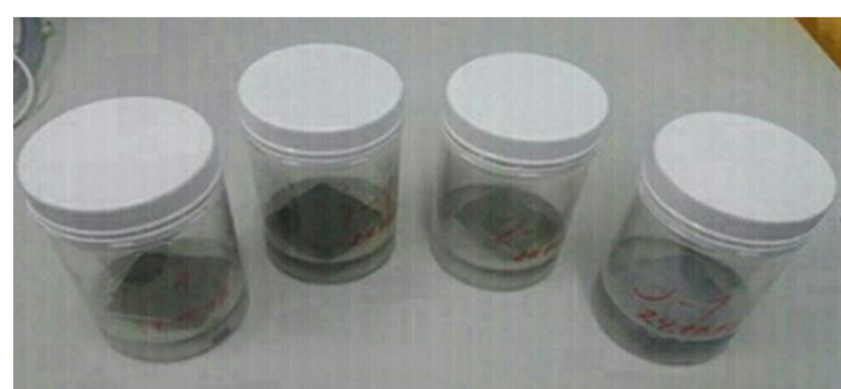
Цементные матрицы погружённые в выщелачивающую воду
