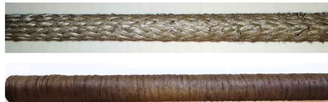
Внешний вид образцов после стадии пропитки волокнистого каркаса из SiC и C газообразным МС и осаждения карбида кремния методом CVI/CVD
