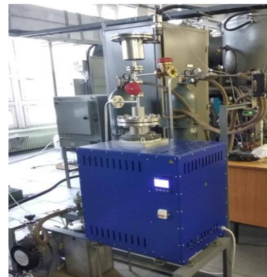
Экспериментальная установка пропитки и осаждения SiC методом CVI/CVD
